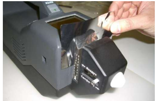
Анализ частиц на пробоотборной салфетке
