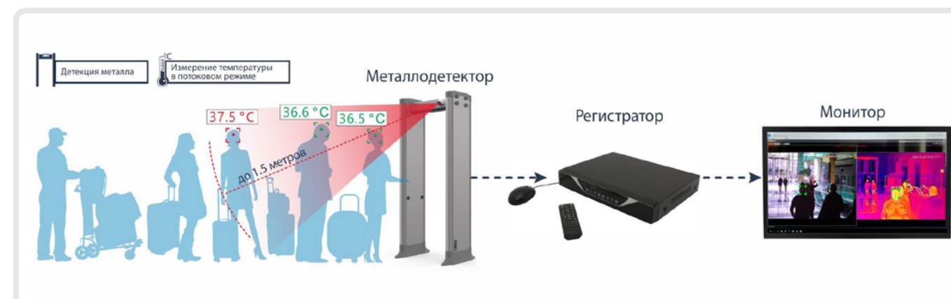
Принцип действия тепловизионной камеры БЛОКПОСТ Delta 100
