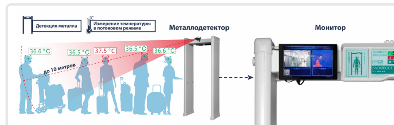
Принцип действия тепловизионной камеры БЛОКПОСТ Delta 100
