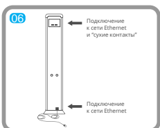
06 Подключение к сети Ethernet и "сухие контакты".
