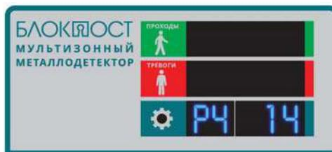
После выбора значения «РЧ» необходимо металлодетектор перезагрузить клавишей «7» - «ВКЛ/ВЫКЛ», металлодетектор пройдёт самодиагностику и перейдёт в рабочий режим.
